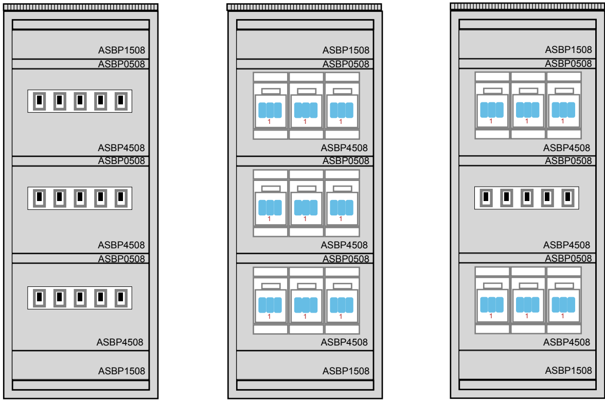
ELŐLNÉZET: MEGSZAKÍTÓS MEZŐ ALSÓ / FELSŐ CSATLAKOZÁS
